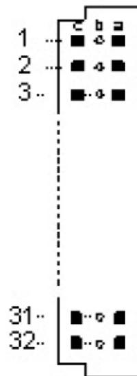
Рисунок 8 — Подключение абонентских линий к разъему платы SLAC
