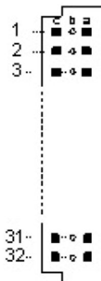
Рисунок 11 — Подключение абонентских линий к разъему платы FXO
