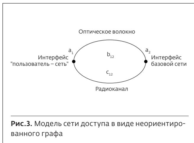
Рис.3. Модель сети доступа в виде неориентированного графа
